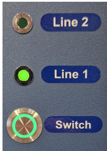
Abbildung 20.2 Der Linienwechselschalter des MIRI® TL12 Mehrraum-IVF-Inkubators und eine aktive Linie 1
