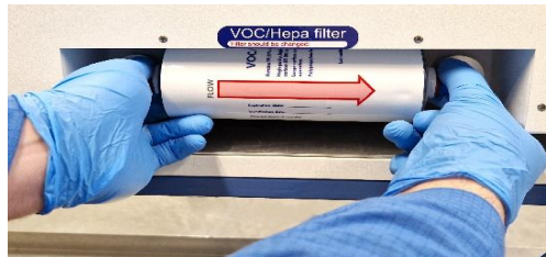
Abbildung 12.2 Verfahren zum Einsetzen und Entfernen des LCKW/HEPA-Filters
