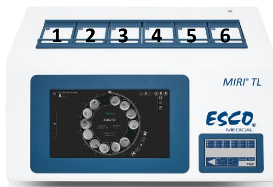
Abbildung 7.1 Kammernummern auf dem Mehrraum-IVF-Inkubator MIRI® TL6
